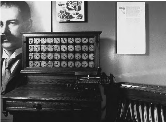
Bild 6/22: Die elektromechanische Zähl- und Sortiermaschine von Hermann Hollerith verwendete erstmals 1886 die Lochkarte als Datenträger (Digital Computermuseum Boston).
