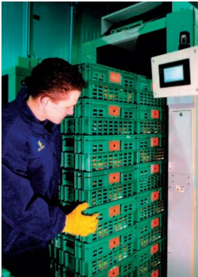
Dieser Detektor kann gleichzeitig alle RFID-Tags eines Palettes erfassen (Bild: Tibbett & Britten)
