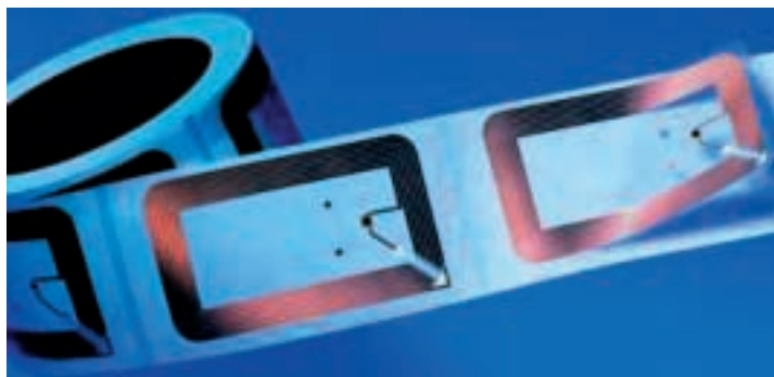
Die RFID-Tags werden als Folien ab Rolle abgezogen und mit einem Träger verbunden
