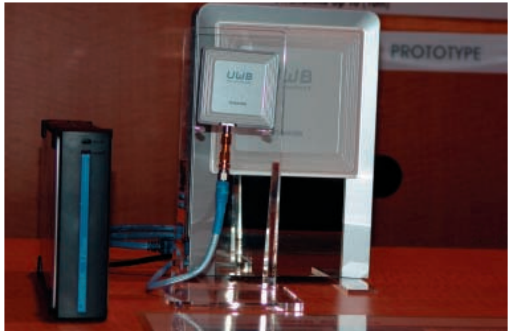
Toshiba stellte einen Prototypen eines Ultra Wideband-Senders vor, welcher in einem Radius von zehn Metern eine Bandbreite von 480 Mbps erreichen kann; vollauf genügend für HD-Übertragung
