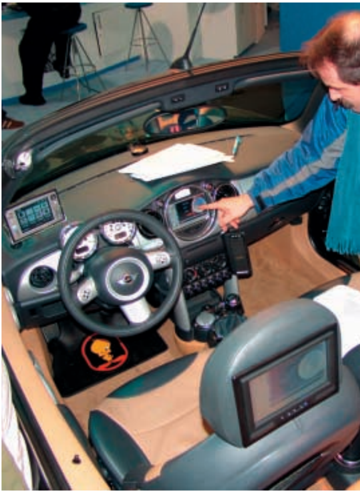
Anziehungspunkt am Intelstand war ein voll ausgebautes MINI Cooper Cabrio mit Entertainment-Displays für die Beifahrer (DVD, Internet, Mail, Gaming usw.). Der eingebaute PC befindet sich unterhalb des grossen Runddisplays in der Konsolenmitte. Mittels Touchscreen oder Sprachbefehle lassen sich alle Funktionen wie Navigation, TV, DVD, Musik, Telefon, Internet, Mail, Bilder und Spiele abrufen und auf die einzelnen Displays verteilen
