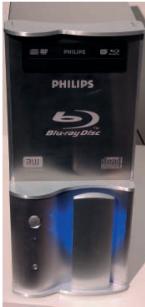
Philips stellt einen PC vor, der mit einem Triple-Laufwerk ausgerüstet war. Dieses Laufwerk kann sowohl CDs, DVDs und Blu-ray Discs lesen und beschreiben. Dazu sind drei unterschiedliche Laserköpfe notwendig, da alle drei Medien mit unterschiedlichen Wellenlängen (CD: 780 nm, DVD: 650 nm, BD: 405 nm) bearbeitet werden. Meist kommt ein Kopf zum Einsatz mit drei eingebauten Lasern
