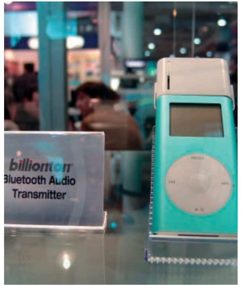
Dieser Bluetooth Audio Transmitter wird auf einen iPod aufgesteckt und überträgt die Musik drahtlos zu einem Bluetooth-Kopfhörer oder zur HiFi-Anlage mit einem Bluetooth-Adapter
