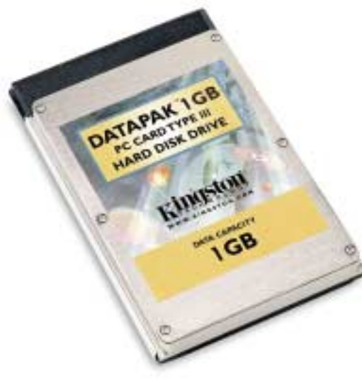
Miniaturisierte Festplatten auf der Basis des PC-Card Typ II-Formates, lassen sich mit Kapazitäten bis zu fünf Gigabyte herstellen
