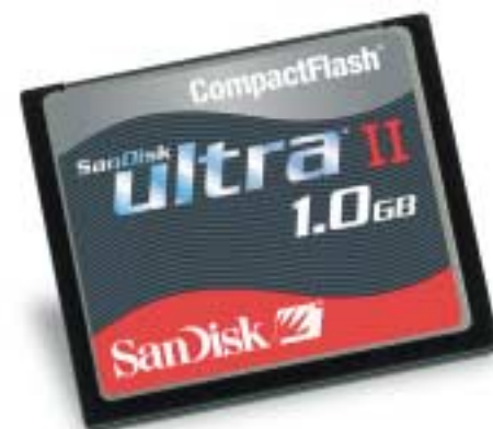
CompactFlash-Karte (Typ I oder II) mit maximal einem Gigabyte Speicherkapazität
