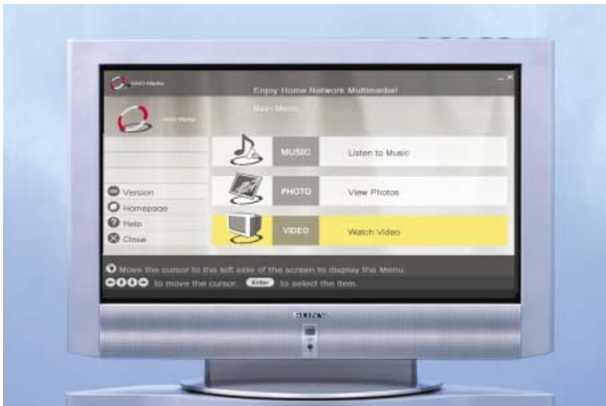
Auf dem Bildschirm des Fernsehers erscheint das Steuer­menü für die Ab­spielung unterschiedlicher Medien. Der Fern­seher ist dabei über einen Mediaemp­fänger (rechts) und das lokale Netzwerk mit dem Home­server verbunden
