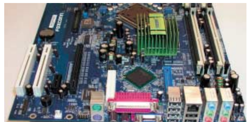
Foxconn präsentierte auf der Cebit 2004 als einer der Ersten ein Mainboard im Micro-BTX-Formfaktor. Als Chipsatz kommt im GDS01-G-TD-Board der Intel Grantsdale G (mit Kühlkörper) mit ICH6R (vorne Mitte) zum Einsatz. Links vorne sind die beiden «alten» PCI-Steckplätze, daneben ein kurzer PCI-Express x1-Steckplatz (schwarz) und ein längerer schwarzer PCI-Express x16-Steckplatz für die neuen Grafikkarten
