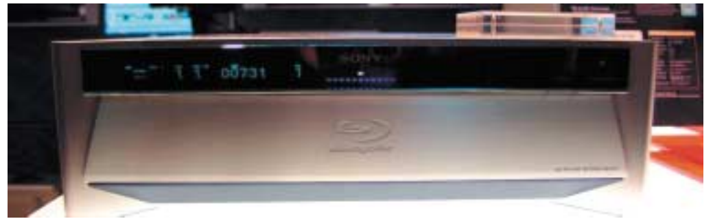
Sony zeigte ihren ersten Blue Ray Disk-Recorder, der zwei Stunden HD-TV in japanischer Codierung (BS-Digital) aufzeichnen kann oder 12 Stunden Standard-TV-Signale
