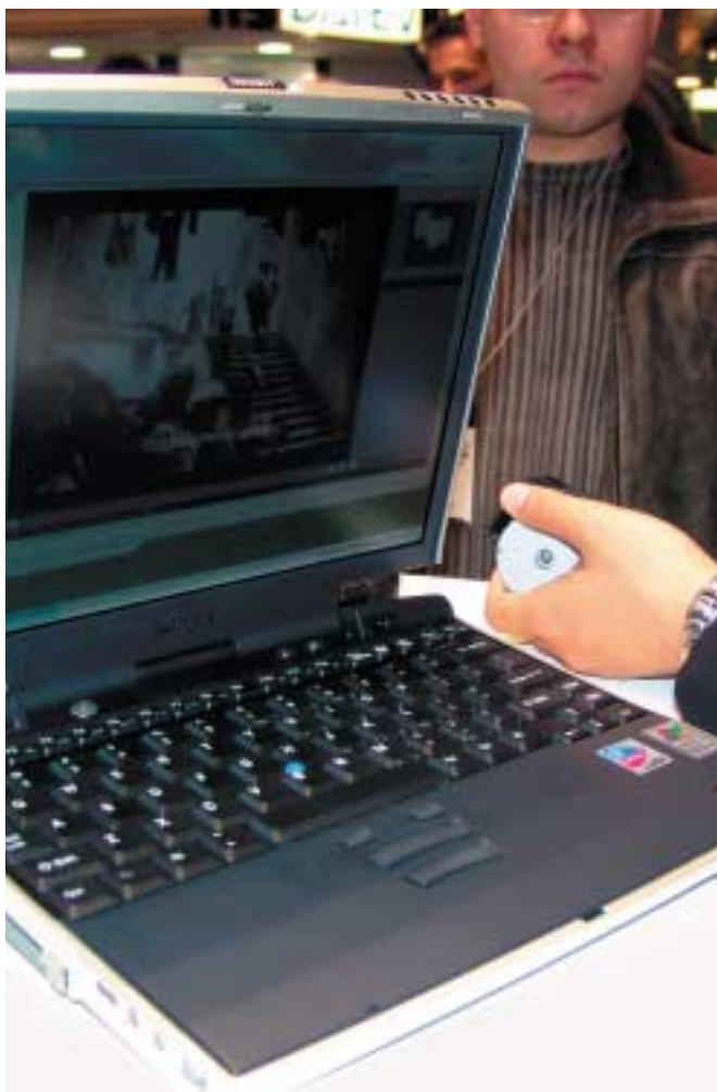
Toshiba zeigte einen Notebook, das mit einer Methanol-Brennstoffzelle (Teil in der Hand) anstelle der Batterie betrieben wird. Damit kann ein Notebook acht bis zwölf Stunden betrieben werden und durch das einfache Nachfüllen mit Methanol wird die Brennstoffzelle wieder neu geladen
